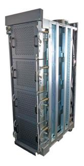
IBM z14 z14 Microprocessor 32 CPUs @ 5.2 GHz **8 TB DRAM**
